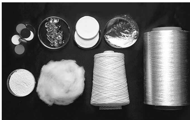
شکل ۱- مواد اولیه به دست آمده از پروتئین تخمیر شده: الیاف پروتئینی، فیلم، پلاستیک و سایر مواد اولیه تولید شده به روش اختصاصی تخمیر کمپانی اسپایبر.
