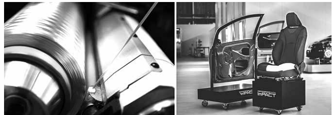
شکل ۲- نخ‌های تهیه شده از پروتئین تخمیر شده (سمت چپ) که با استفاده از فرایند اسپایر برای استفاده در بخش پوشاک و خودروسازی (سمت راست) تولید شده‌اند.
